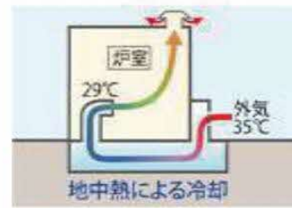
地中熱換気システム
