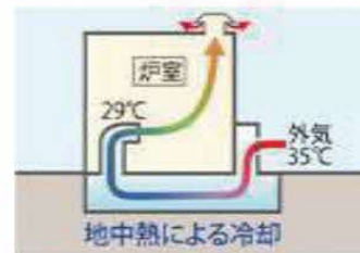
地中熱換気システム
